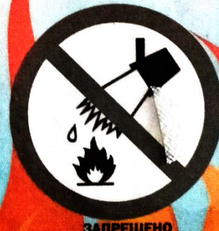
ЗАПРЕЩЕНО ТУШИТЬ ВОДОЙ
